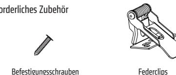
2. Befestigen Sie die Federclips an der Rückseite des LED Panels.
