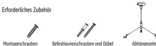
2. Befestigen Sie die Abhängeseile. Verwenden Sie hierfür die dem Produkt beiliegenden Schrauben und Dübel.
