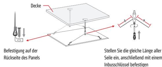
4. Stellen Sie die Abhängeseile auf die gewünschte Höhe ein. Nutzen Sie hierzu die Verstellhülse an der Decke.
