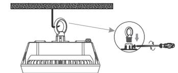
3. Schließen Sie die Lampe gemäß dem unten aufgeführten Schema an die Stromversorgung an. Nehmen Sie die Leuchte anschließend in Betrieb.
